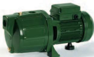
Горизонтальные многоступенчатые центробежные насосы серии MJ предназначены для подачи чистой холодной воды из открытых водоемов, накопительных резервуаров, неглубоких колодцев и скважин. Способны всасывать воду с глубины 8–9 м. Максимальная температура перекачиваемой жидкости +35°C, максимальная температура окружающей среды +40°C.
