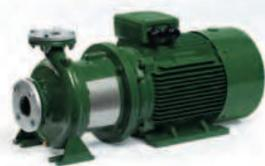
Центробежные консольные насосы высокой производительности с коротким валом серии CNG с одним рабочим колесом предназначены для перекачивания чистых, невзрывоопасных жидкостей без абразивных примесей и твердых взвесей, неагрессивных к материалам деталей насоса. Максимальная температура перекачиваемой жидкости +35°C, максимальная температура окружающей среды +40°C.
