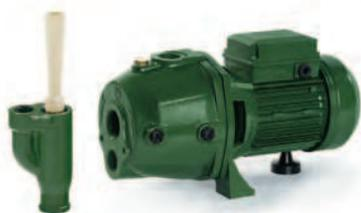
Насосы серии JAP- поверхностные насосы с внешним эжектором, предназначены для подачи чистой холодной воды из скважин диаметром не менее 4" (100 мм), глубоких колодцев и других источников водоснабжения, когда высота всасывания превышает 8 м, кроме того, они могут быть использованы в автоматических системах водоснабжения.
