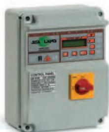
Электронный однофазный пульт управления CBX 05/300 с защитой от «сухого хода» без контроля уровня жидкости и защитой двигателя по предельно допустимому рабочему току предназначен для управления работой одного однофазного погружного насоса.
