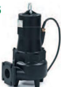
Погружные дренажные электрические насосы с незабывающимся рабочим колесом вихревого типа серии DV25 предназначены для откачки жидкостей с содержанием твердых частиц, размером до 62 мм во взвеси, химически неагрессивных для материалов, из которых выполнен насос, с максимальной температурой не выше 35°C.
