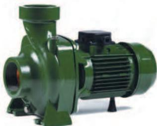
Центробежные консольные насосы высокой производительности серии KL с одним рабочим колесом предназначены для перекачивания чистых, невзрывоопасных жидкостей без абразивных примесей и твердых взвесей, неагрессивных к материалам деталей насоса. Максимальная температура перекачиваемой жидкости +35°C, максимальная температура окружающей среды +40°C.
