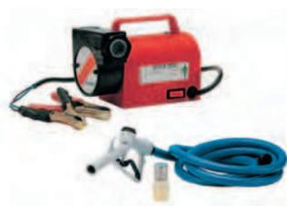
QUICK MINI – низковольтный самовсасывающий лопастной электронасос объемного типа со встроенным перепускным клапаном (бай-пассом). Комплектуется фильтром на всасывающей магистрали, 4-х метровым раздаточным шлангом с пластиковым пистолетом, электрокабелем длиной 1 м с клипсами.
