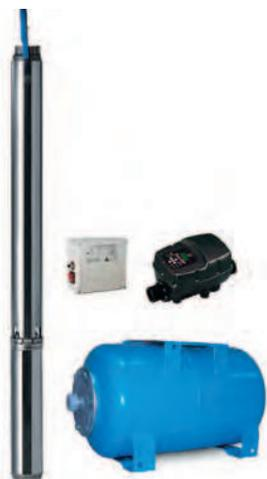
Станции автоматического водоснабжения серии SL-SIRIO на базе погружных скважинных насосов серии SL с преобразователем частоты SIRIO ENTRY 230, предназначены для подачи чистой холодной воды из глубоких колодцев, скважин и других источников и поддержания давления воды в системе водоснабжения в автоматическом режиме. Станции обеспечивают стабильное давление в водопроводной сети независимо от уровня потребления воды.
