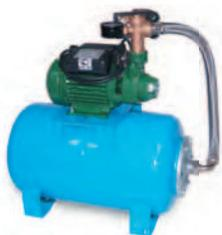
Станции автоматического водоснабжения серии AUTO ONDINA на базе самовсасывающих поверхностных вихревых насосов ONDINA предназначены для подачи чистой холодной воды из открытых источников, накопительных резервуаров, неглубоких колодцев и скважин и для поддержания давления воды в системе водоснабжения в автоматическом режиме.
