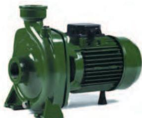
Центробежные консольные насосы серии КС с одним рабочим колесом предназначены для перекачивания чистых, невзрывоопасных жидкостей без абразивных примесей и твердых взвесей, неагрессивных к материалам деталей насоса. Максимальная температура перекачиваемой жидкости +35°C, максимальная температура окружающей среды +40°C.
