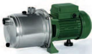
Горизонтальные многоступенчатые центробежные насосы серии MJX предназначены для подачи чистой холодной воды из открытых водоемов, накопительных резервуаров, неглубоких колодцев и скважин. Способны всасывать воду с глубины 8–9 м. Максимальная температура перекачиваемой жидкости +35°C, максимальная температура окружающей среды +40°C.
