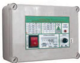
Электромеханический однофазный пульт управления CDA M с тепловой защитой и пусковым конденсатором 85 мкФ предназначен для управления работой одного однофазного дренажного или погружного насоса. Автоматическое включение и выключение насоса. Вход для внешнего устройства управления (реле давления или поплавкового выключателя). Тепловая защита с кнопкой перезапуска. Индикация неисправности (красный светодиод). Корпус из термостойкого пластика. Класс защиты – IP54.
