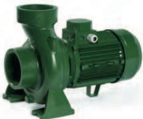
Центробежные консольные насосы высокой производительности серии KXL с одним рабочим колесом предназначены для перекачивания чистых, невзрывоопасных жидкостей без абразивных примесей и твердых взвесей, неагрессивных к материалам деталей насоса. Максимальная температура перекачиваемой жидкости +35°C, максимальная температура окружающей среды +40°C.
