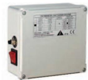
Электромеханический однофазный пульт управления CBX с пусковым конденсатором и тепловой защитой предназначен для управления работой одного однофазного погружного насоса для водоснабжения. Автоматическое включение и выключение насоса. Вход для реле давления или поплавкового выключателя. Тепловая защита с кнопкой перезапуска. Корпус из термостойкого пластика. Класс защиты – IP50.
