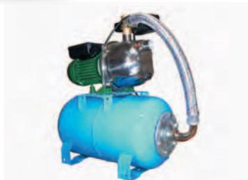
Станции автоматического водоснабжения серии AUTO JEXI на базе самовсасывающих поверхностных насосов JEXI с внутренним эжектором предназначены для подачи чистой холодной воды из открытых источников, накопительных резервуаров, неглубоких колодцев и скважин и для поддержания давления воды в системе водоснабжения в автоматическом режиме.
