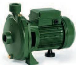
Центробежные консольные насосы серии К с одним рабочим колесом предназначены для перекачивания чистых, невзрывоопасных жидкостей без абразивных примесей и твердых взвесей, неагрессивных к материалам деталей насоса. Максимальная температура перекачиваемой жидкости +35°C, максимальная температура окружающей среды +40°C.
