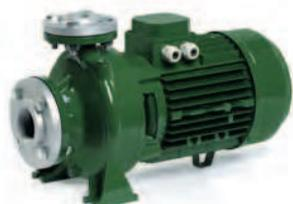
Центробежные консольные насосы высокой производительности серии CN с одним рабочим колесом предназначены для перекачивания чистых, невзрывоопасных жидкостей без абразивных примесей и твердых взвесей, неагрессивных к материалам деталей насоса. Максимальная температура перекачиваемой жидкости +35°C, максимальная температура окружающей среды +40°C.
