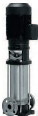
Вертикальные многоступенчатые центробежные насосы MVX предназначены для перекачивания чистых, невзрывоопасных жидкостей без абразивных примесей и твердых взвесей, неагрессивных к материалам деталей насоса. Максимальная температура перекачиваемой жидкости +90°C, максимальная температура окружающей среды +40°C.
