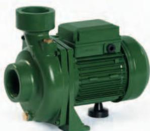
Центробежные консольные насосы средней производительности серии КР с одним рабочим колесом предназначены для перекачивания чистых, невзрывоопасных жидкостей без абразивных примесей и твердых взвесей, неагрессивных к материалам деталей насоса. Максимальная температура перекачиваемой жидкости +35°C, максимальная температура окружающей среды +40°C.
