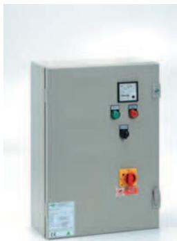
Электромеханический трехфазный пульт управления серии CBS с запуском двигателя по схеме звезда-треугольник и термозащитой предназначен для управления трехфазными насосами, мощностью от 7,5 до 30 кВт.
