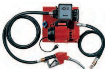
В состав станции входят: насос QUICK MAXI, всасывающий шланг 4 метра с латунным обратным клапаном и концевым фильтром, 4-х метровый раздаточный шланг с пластиковым пистолетом, счетчик перекачиваемой жидкости, электрокабель длиной 1 м с вилкой.
