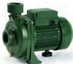
Центробежные консольные насосы серии КА с одним рабочим колесом предназначены для перекачивания чистых, невзрывоопасных жидкостей без абразивных примесей и твердых взвесей, неагрессивных к материалам деталей насоса. Максимальная температура перекачиваемой жидкости +35°C, максимальная температура окружающей среды +40°C.
