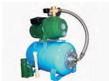
Станции автоматического водоснабжения серии AUTO JAP на базе самовсасывающих поверхностных насосов JAP с внешним эжектором предназначены для подачи чистой холодной воды из открытых источников, накопительных резервуаров, колодцев и скважин, когда высота всасывания превышает 8 м, и для поддержания давления воды в системе водоснабжения в автоматическом режиме.
