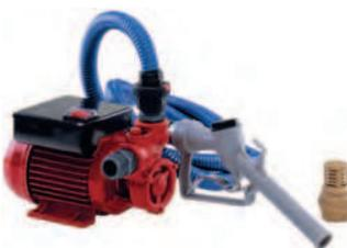
QUICK MIDI – электрический насос вихревого типа. Комплектуется фильтром на всасывающей магистрали, латунным обратным клапаном, 4-х метровым раздаточным шлангом с пластиковым пистолетом, выключателем, электрокабелем длиной 1 м с вилкой.
