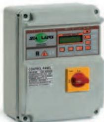
Электронный трехфазный пульт управления CBT с защитой от «сухого хода» без контроля уровня жидкости и защитой двигателя по предельно допустимому рабочему току предназначен для управления работой одного трехфазного погружного насоса.
