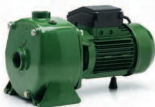
Центробежные консольные насосы серии KD с двумя рабочими колесами предназначены для перекачивания из бассейнов и накопительных резервуаров чистых, невзрывоопасных жидкостей без абразивных примесей и твердых взвесей, неагрессивных к материалам деталей насоса. Максимальная температура перекачиваемой жидкости +35°C, максимальная температура окружающей среды +40°C.
