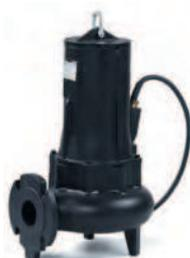
Погружные дренажные электрические насосы с незабывающимся рабочим колесом вихревого типа серии DV30 предназначены для откачки жидкостей с содержанием твердых частиц, размером до 67 мм во взвеси, химически неагрессивных для материалов, из которых выполнен насос, с максимальной температурой не выше 35°C.
