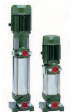
Вертикальные многоступенчатые центробежные насосы MKV предназначены для перекачивания чистых, невзрывоопасных жидкостей без абразивных примесей и твердых взвесей, неагрессивных к материалам деталей насоса. Максимальная температура перекачиваемой жидкости +90°C, максимальная температура окружающей среды +40°C.
