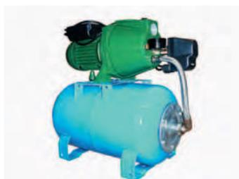
Станции автоматического водоснабжения серии AUTO JET на базе самовсасывающих поверхностных насосов JET с внутренним эжектором предназначены для подачи чистой холодной воды из открытых источников, накопительных резервуаров, неглубоких колодцев и скважин и для поддержания давления воды в системе водоснабжения в автоматическом режиме.
